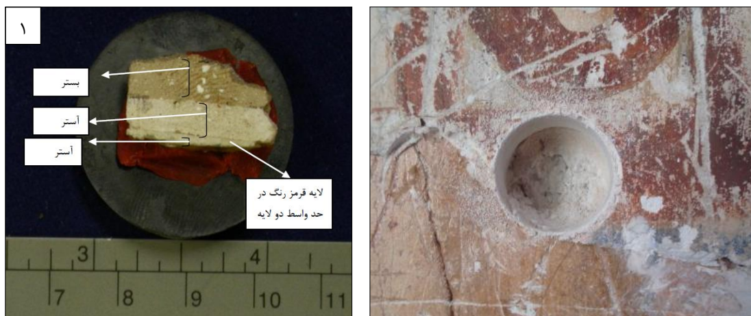
شکل ۴. راست: محل سونداز و نمونه‌برداری از دیوارنگاره جهت آزمایش؛ چپ: نمونه لایه‌های موجود در نقاشی امامزاده حمزه
